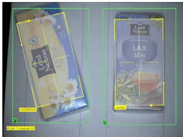
Slika 2 : Strojni vid za razvrščanje paketov
